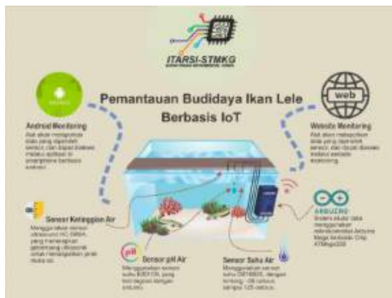
Gambar 5. Prototipe Pemantau Suhu dan pH Air Berbasis IoT
